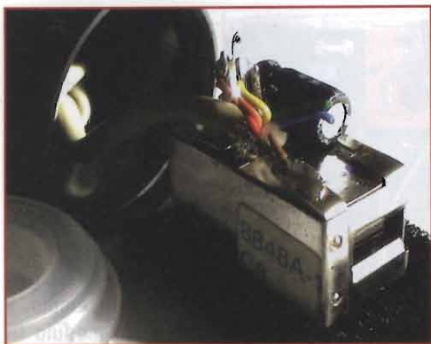
Da sinistra: foto 4: Modulino IR con il suo condensatore di filtro, ancora all'esterno del contenitore per rullini fotografici
