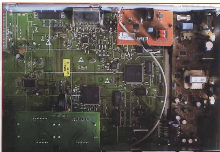
foto 1: In ordine dimensionale: piastra madre, alimentatore switching, interfaccia carte, interfaccia verso linea telefonica del modem
