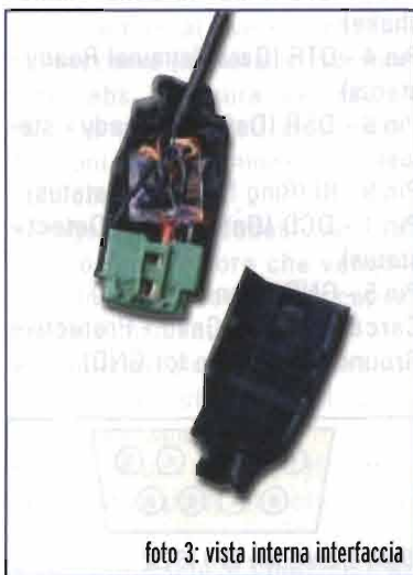
foto 2: cavo e interfaccia interna al connettore nero
