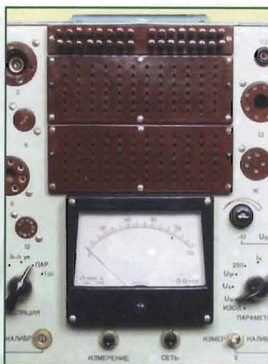
foto 4: le serie di fori atta ad impostare la misura, i parametri generali e i collegamenti ai vari elettrodi
